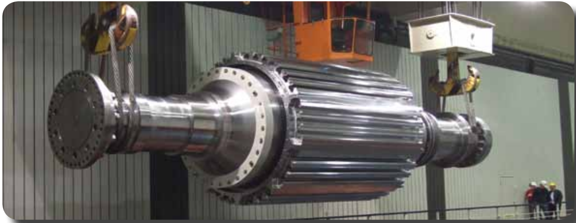
Kraftwerk Wehr: Rotor des Generators mit einem Gewicht von ca. 160 Tonnen
